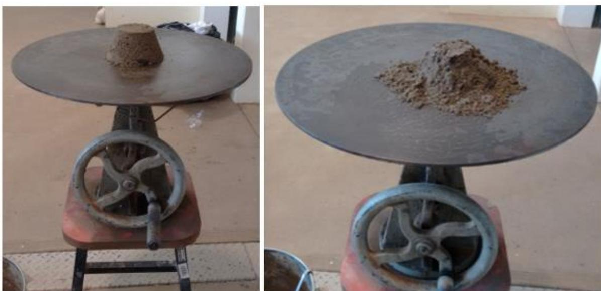
Figura 4.9 – Consistência seca das argamassas sem superplastificante.
